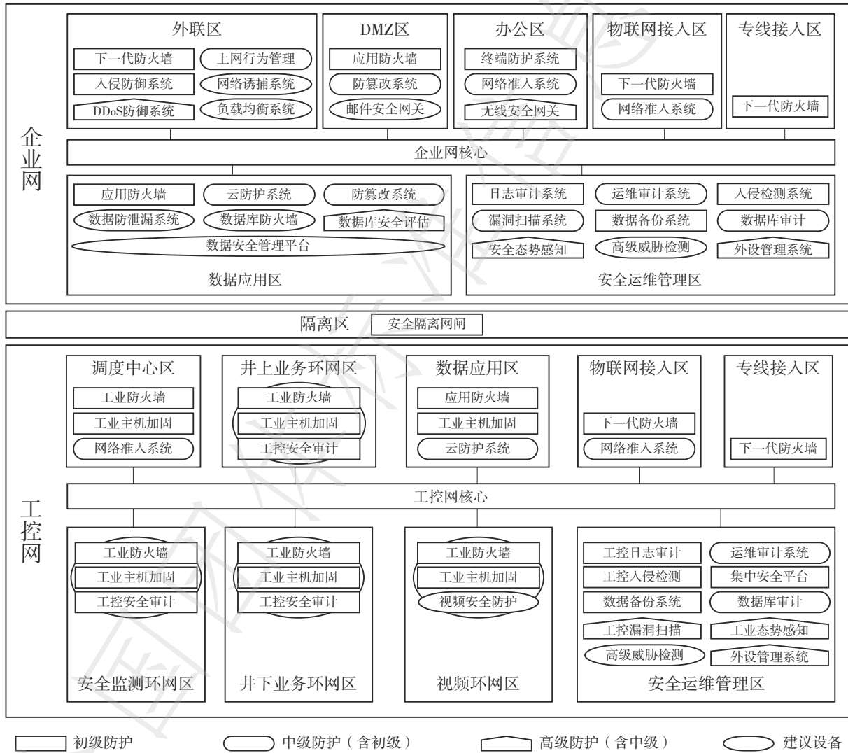
图 A.1 煤矿生产企业网络安全防护示意图
