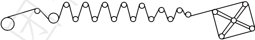
图 A.5 机器浸胶装置示意图
