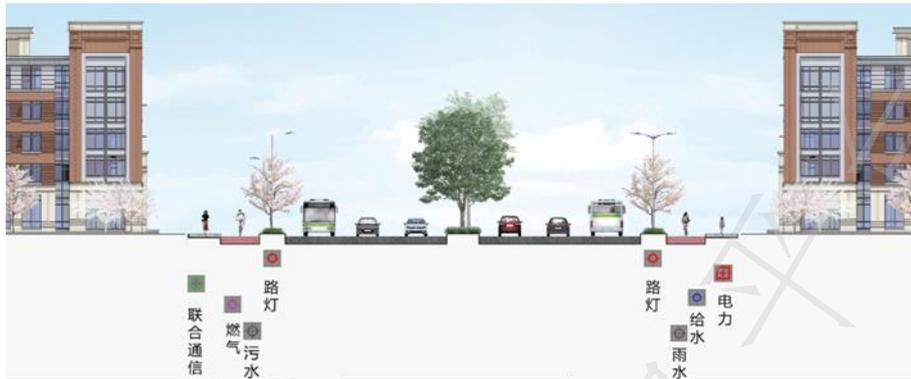
图 18 双向六车道普通国省道市政化改造后断面示意图
