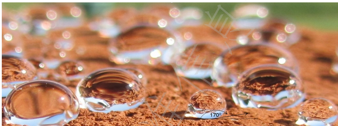
图 A.1 水珠在超疏水土表面的荷叶效应
