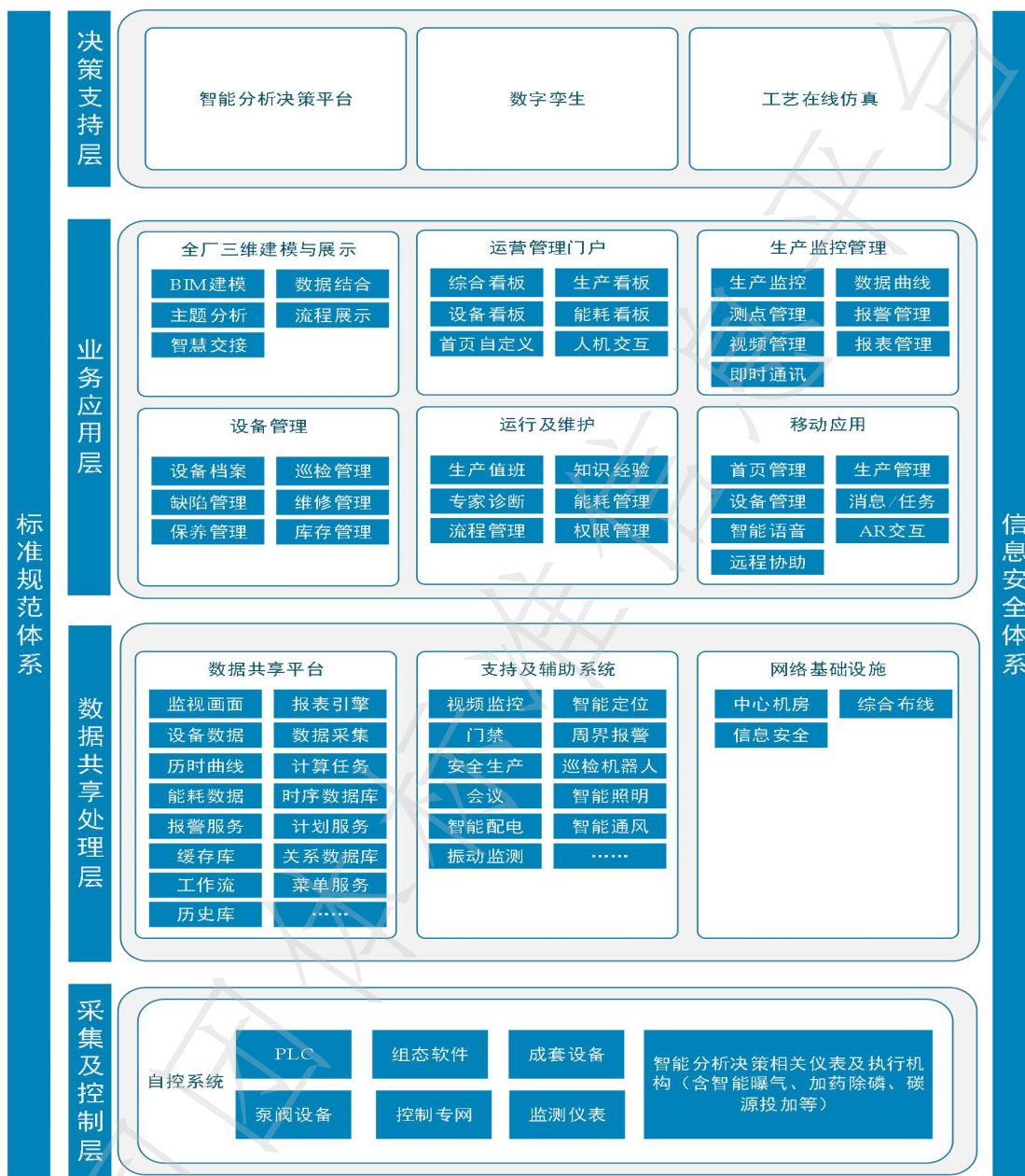
下沉式再生水厂智能化系统架构图
