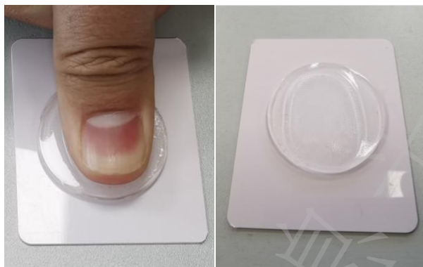
图 A. 8 手指按压模具（非导电）
