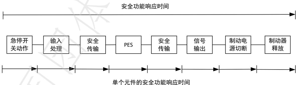
图 3 安全功能响应时间组成部分示例
