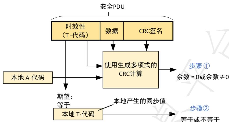
图 B.4 显式 T-代码和隐式 A-代码安全措施模型
