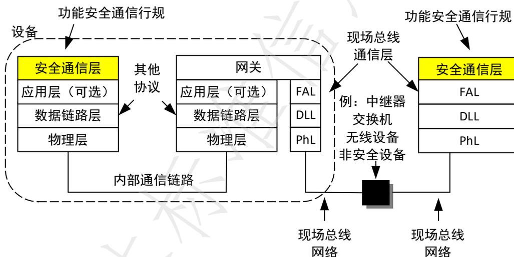
图 A.1 功能安全通信系统模型示例
