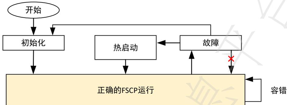
图 15 概念性的 FSCP 协议模型
