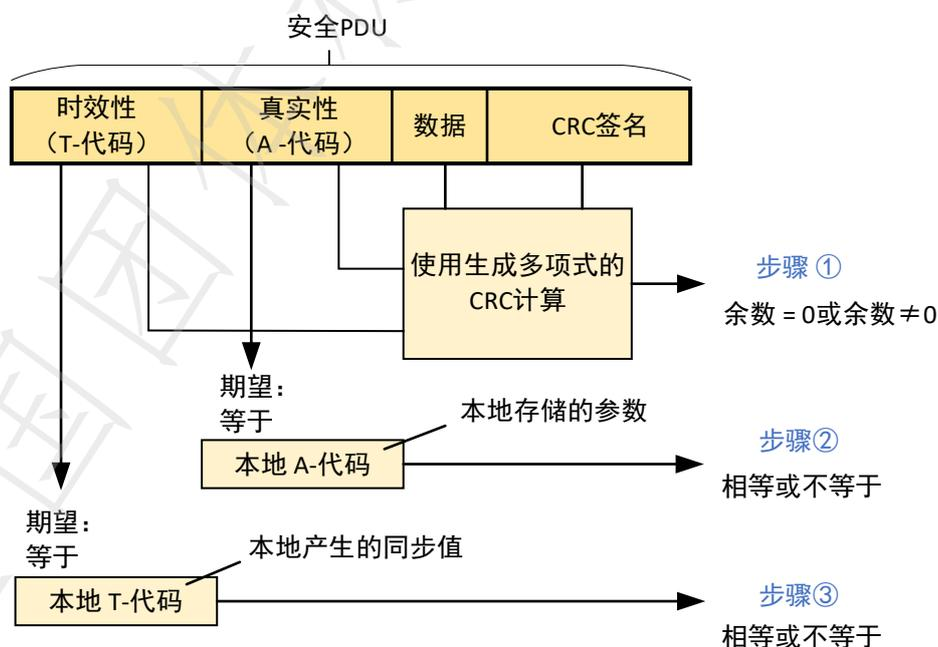
图 B.2 完全显式的安全措施的模型
