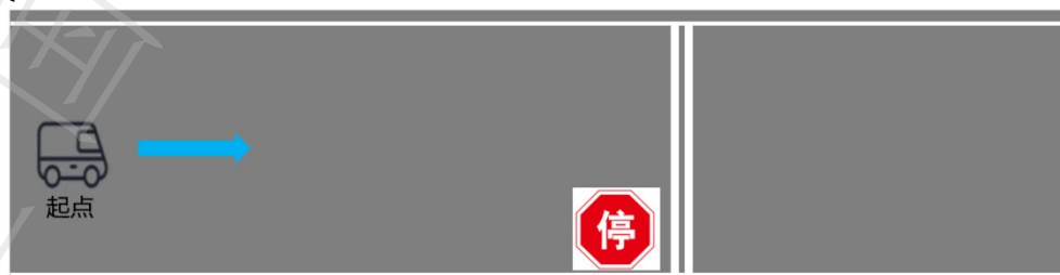
图9 停车让行标志标线识别及响应试验场景示意图
