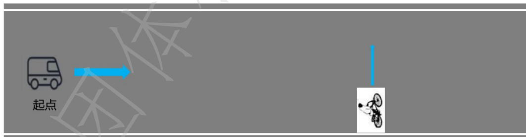
图5 非机动车横穿马路试验场景示意图
