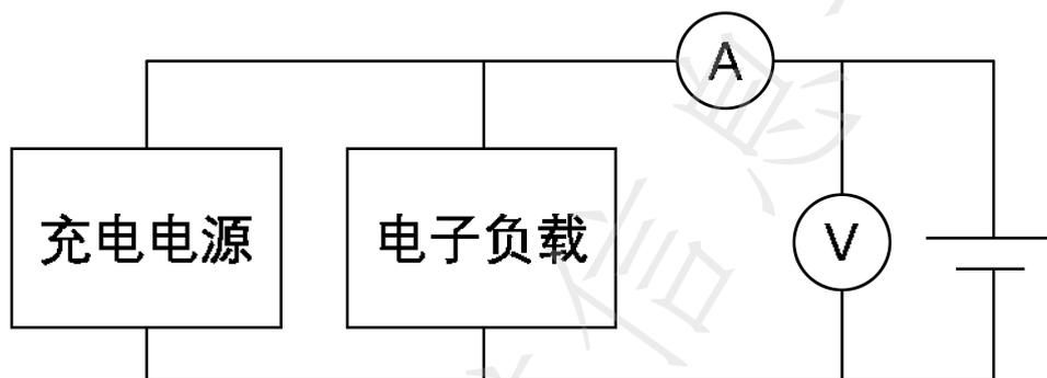
图 A.1 电池检测试验平台
