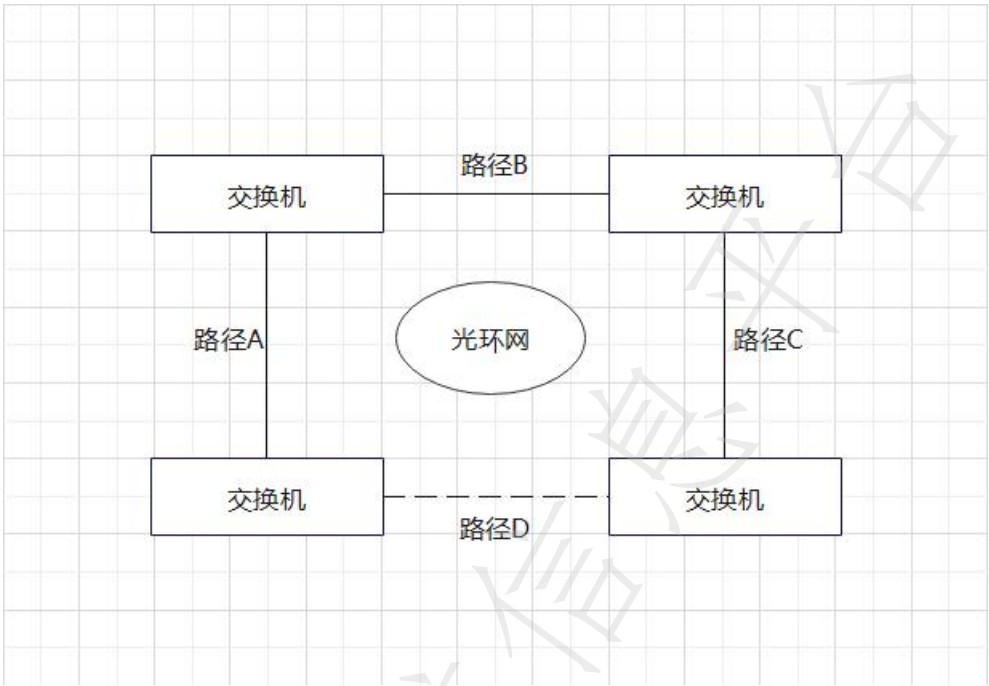
图6 环网恢复时间测试图
