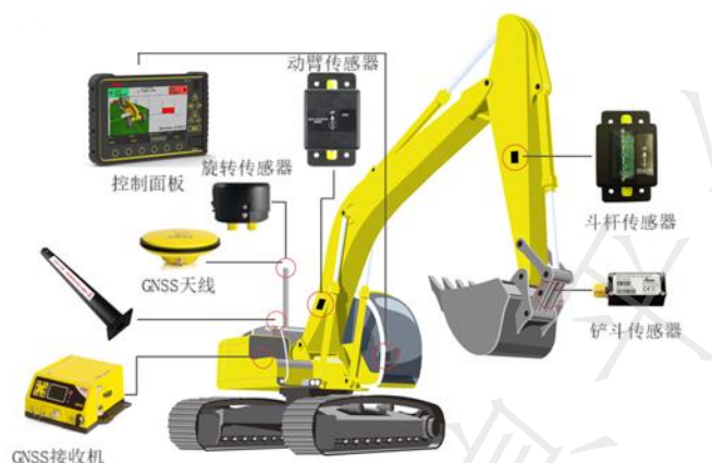
图 1 3D 挖掘引导控制系统车载设备组成示意图
