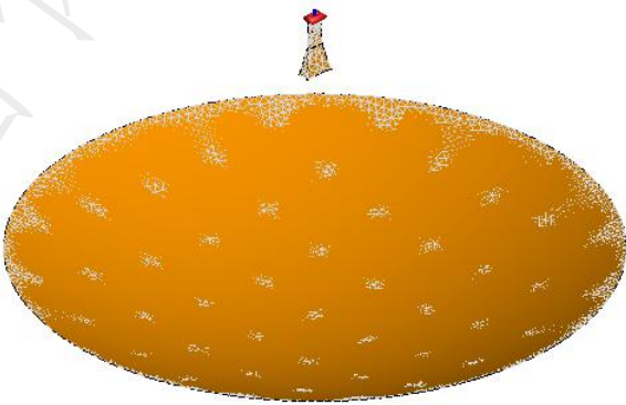
图 A.2 基于电磁参数构建某雷达天线数字样机
