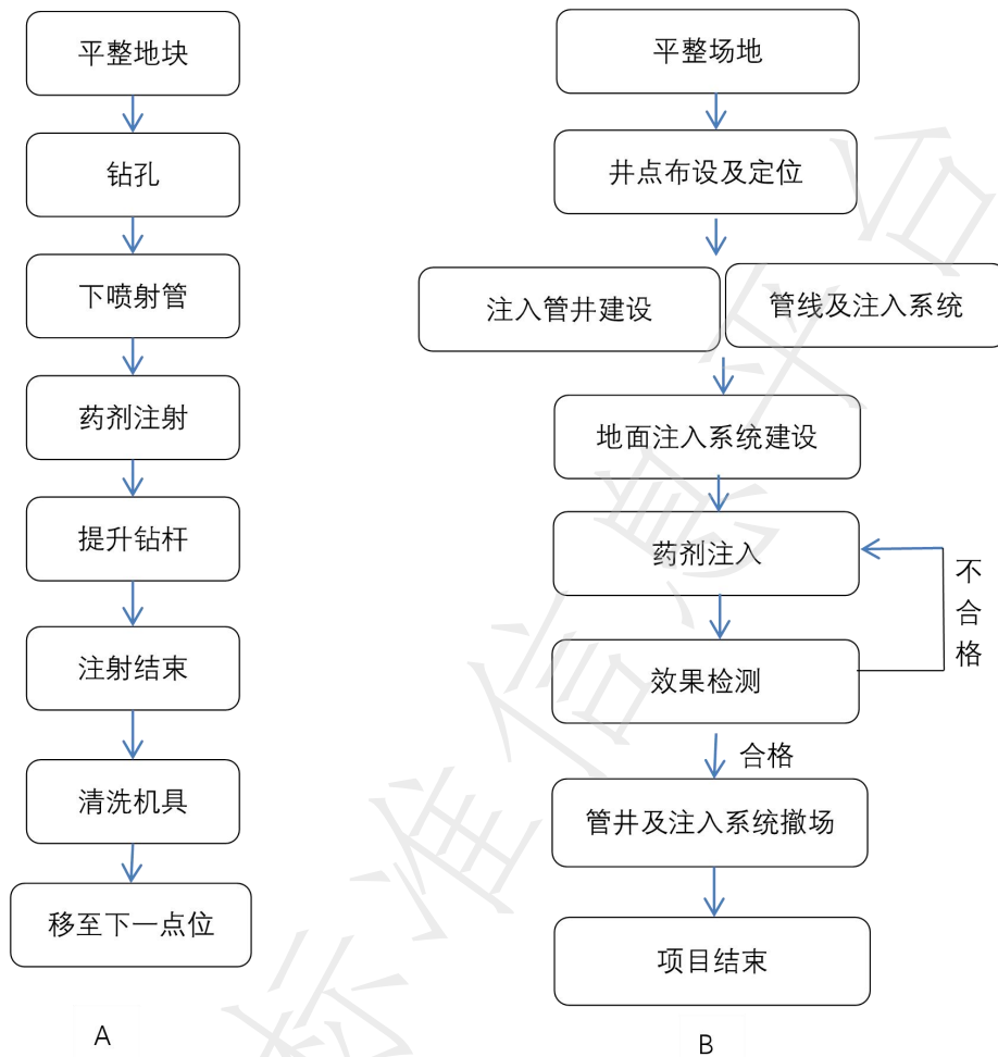
图 7 地块原位化学氧化直推注入 (A) 和建井注入 (B) 工艺流程设计图
