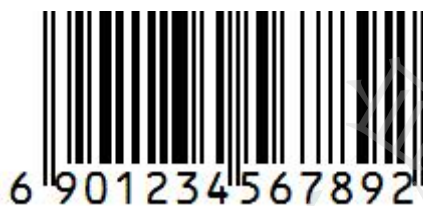
图 C.1 EAN-13 条码示例
