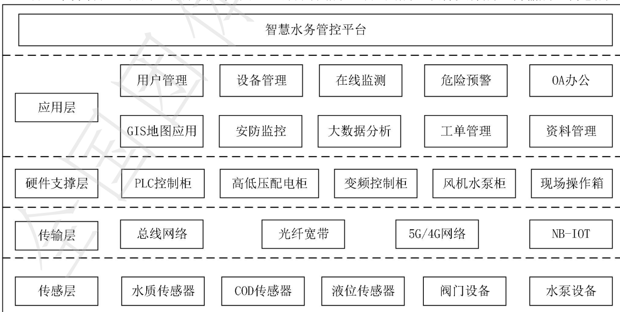
图 1 智慧水务管控平台的总体架构
