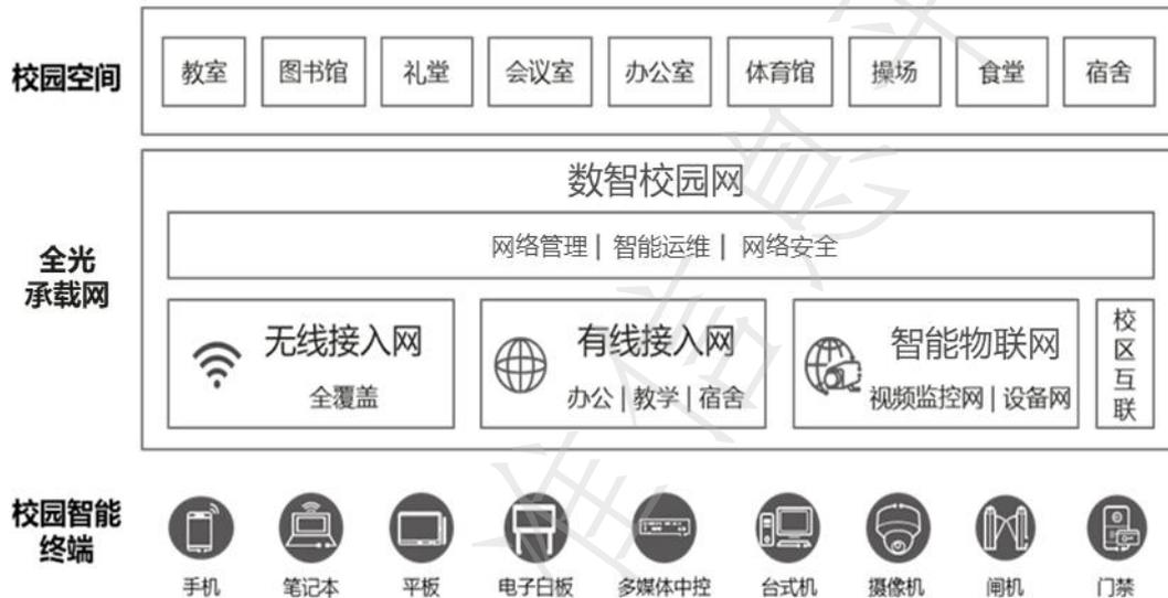
图1 数智校园多业务全光承载网总体架构
