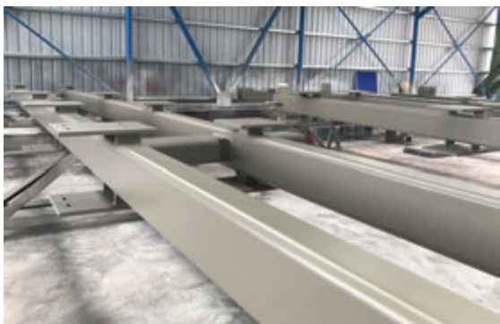
图 3 单组分膨胀型防火体系
