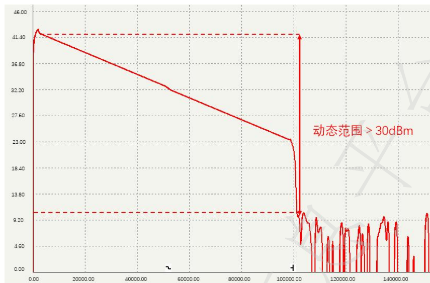
图 2 100km OTDR 测试示例
