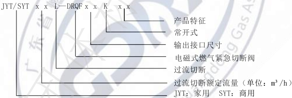
图 5.1.3.1 调压切断阀型号编制
