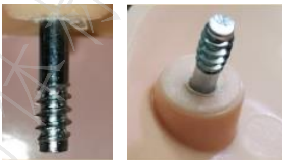
a) 紧固件/自攻牙型（牙部长度应足够长以保证能够通过紧固件扭力测试）
