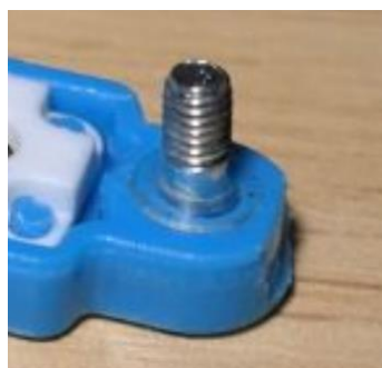
b) 紧固件/机牙螺丝（牙部应有足够的强度以保证能够通过紧固件扭力测试）
