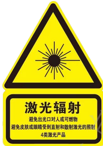
图 4 手持激光焊枪标记示例
