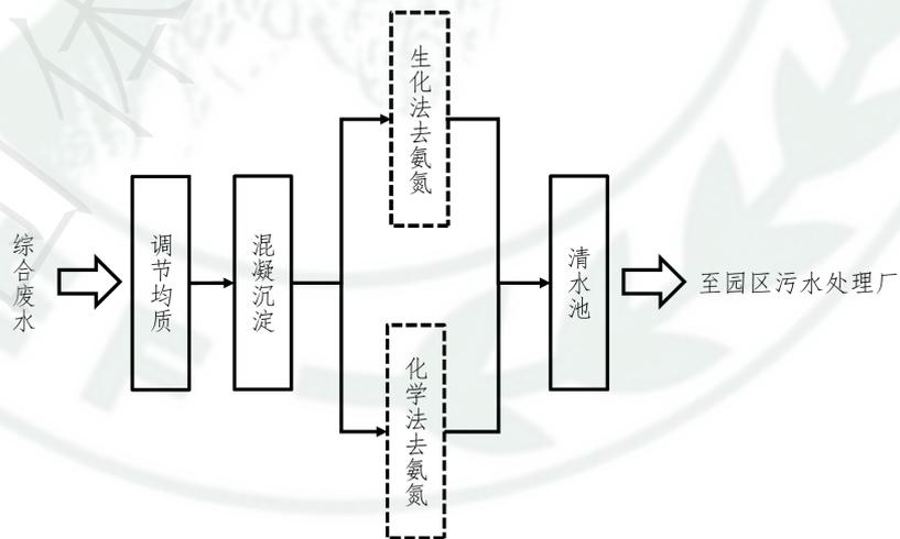
图 2 综合废水处理工艺流程图
