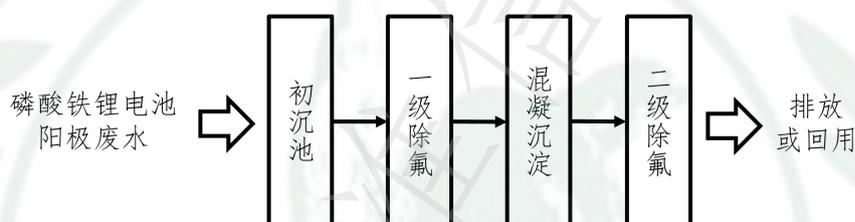
图 4 阳极废水处理工艺流程图
