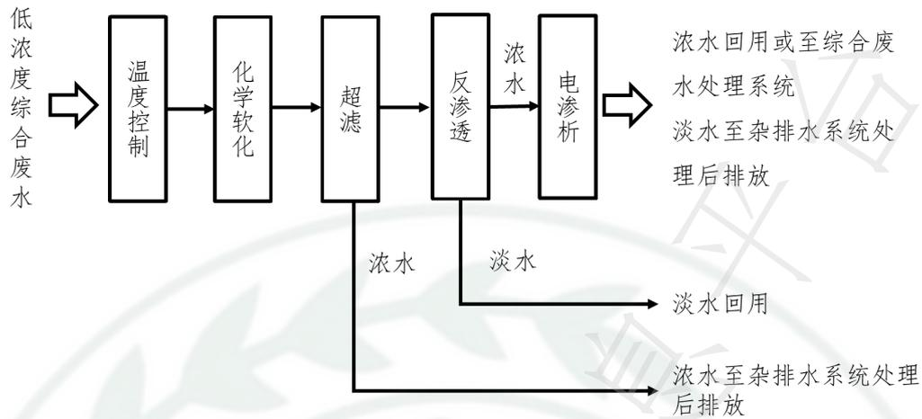
图3 低浓综合废水处理工艺流程图
