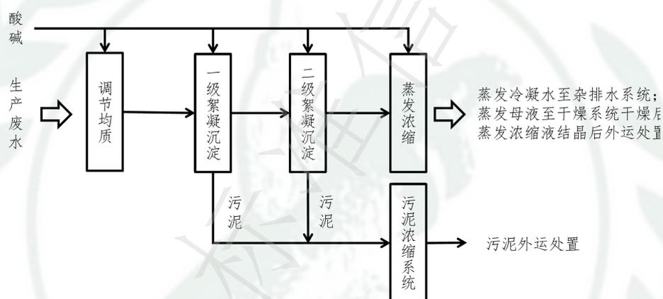
图 1 车间废水处理工艺流程图
