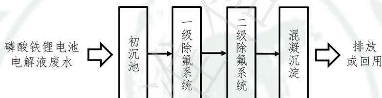
图 5 电解液废水处理工艺流程图
