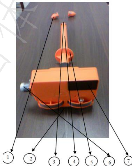
1、锚爪 2、线圈 3、顶爪 4、顶杆 5、托盘 6、通讯接口 7、显示窗
