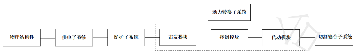
图2 电动吻合器系统可靠性框图（示例）
