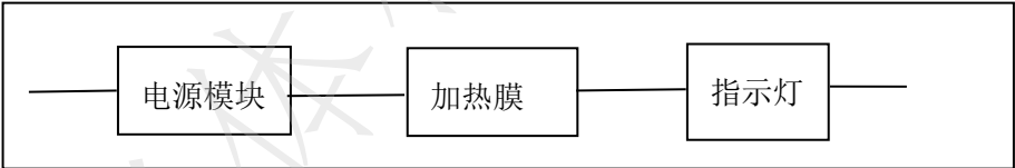
图 5 微生物培养监测仪串联模型可靠性框图
