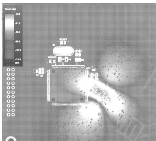
图3 覆盖在 EUT 图像上的数据示例（轮廓图）
