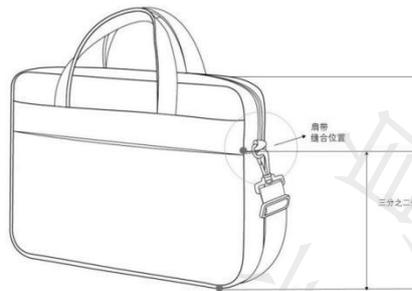
图 9 背带两端与包体连接示意图
