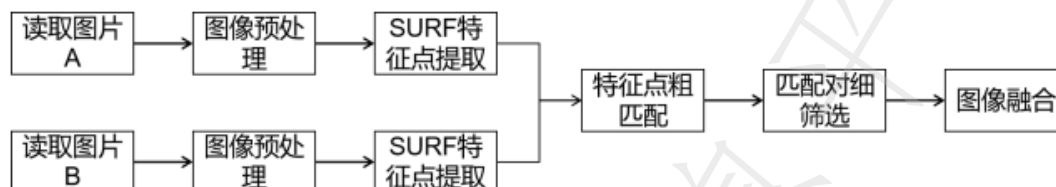
图4 空域融合主板拼接算法流程
