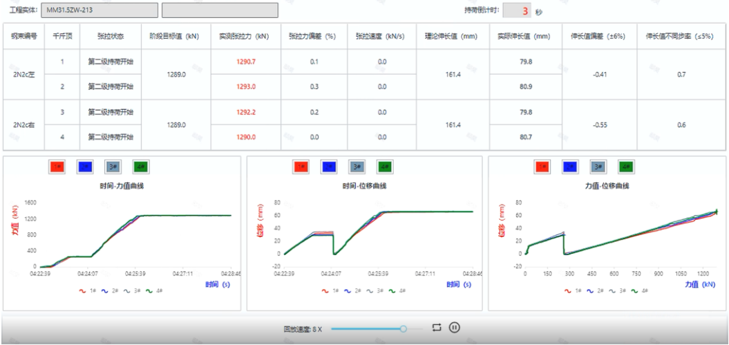
说明图 6.4.8 预应力智能张拉施工过程数据回放
