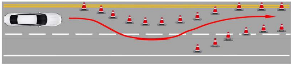
图15 施工区域测试场景示意图
