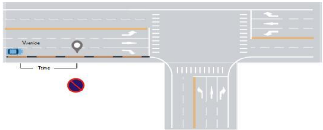
图6 禁止长时停车标志/标线测试场景示意图
