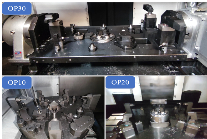
图 6.1 夹具现场安装图
