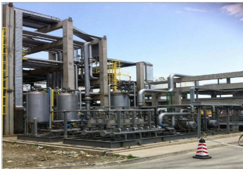
图 5.2 膜分离耦合装置（冷凝+膜）回收有机废气撬块
