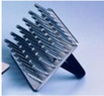
图 2 48 孔板重复铺板器图
