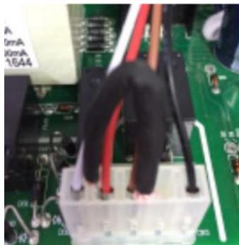
图 C.11 短接比例阀端子
