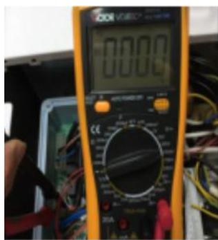
图 C.10 无电压输出
